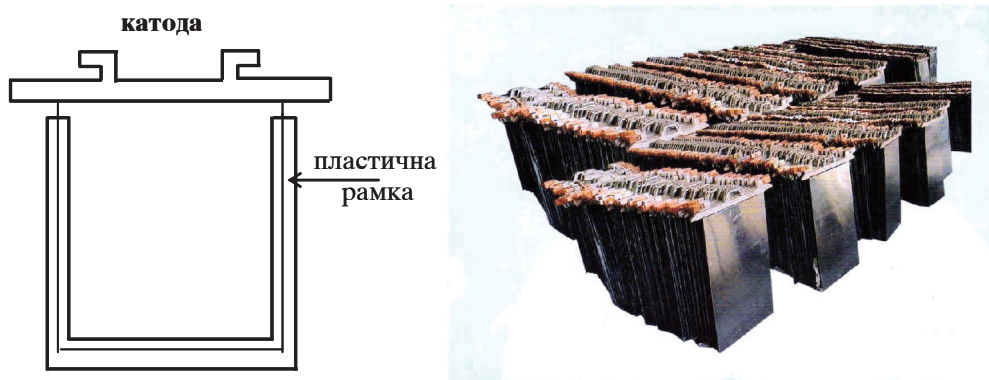
Слика 5-3 Шематски и реален приказ на катоди за електролиза на Zn
