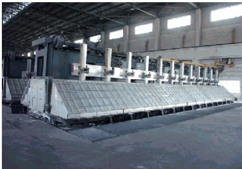
Слика 6-6 Погон за електролиза на Al со дисконтинуирани аноди
