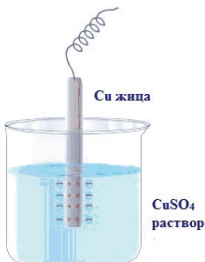
Слика 1-1 Шематски приказ на распоредот на полнежите на бакарна електрода
