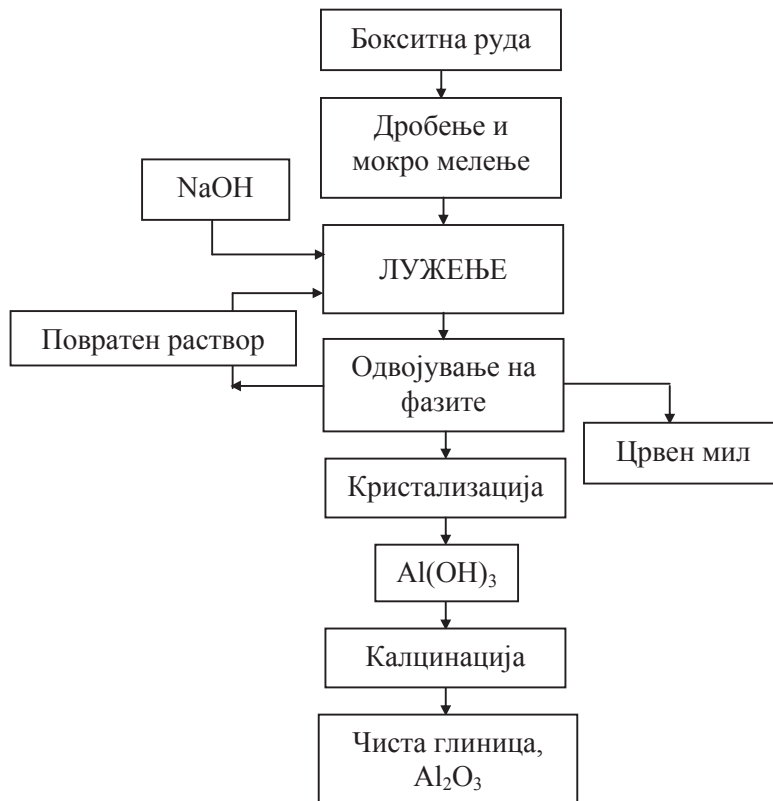
Слика 6-2 Технолошка шема на Баеровиот процес
