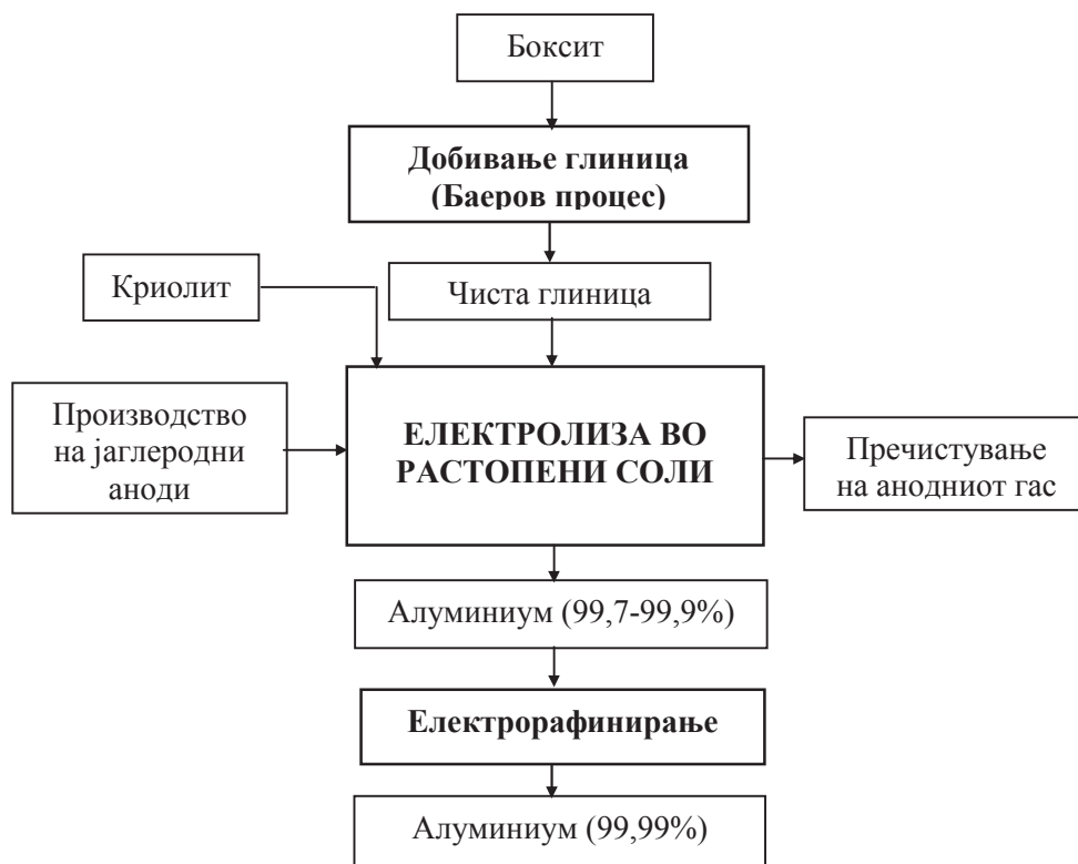
Слика 6-1 Технолошка шема на процесот на добивање алуминиум
